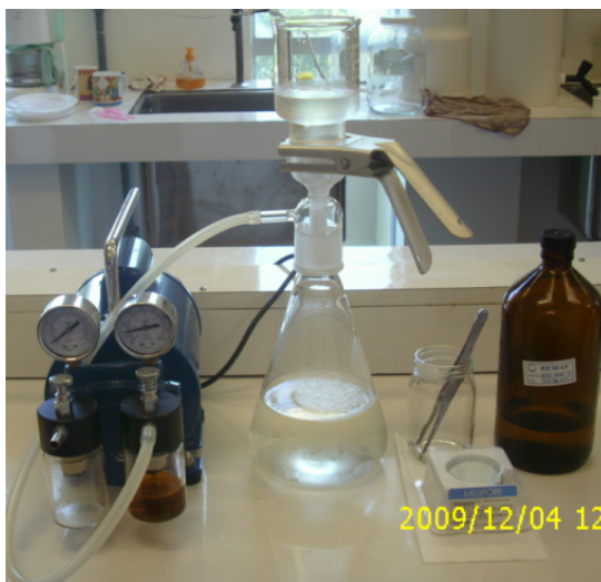
Figura 9 - Sistema montado para a filtração à vácuo das amostras de água subterrânea
