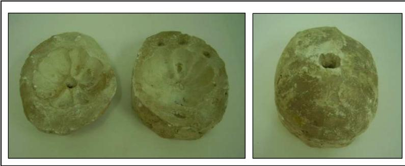
Figura 9 (A, B) - Fotografia de fôrma em gesso número tombo 9347 (A e B) com dimensão A: 5.0 x 12.5 x 16.5 e B: 4.0 x 13.5 x 16.5 cm, em partes e com encaixes; forma fechada com dimensão de 9.0x 12.0 x 16.5 cm
