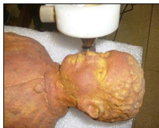
Figura 29 e 30 - Obra “Menino II com Bolinha de Gude” (35.02), ponto a de cor vermelho e ponto b de cor amarelo e equipamento de fluorescência em posição para análise
