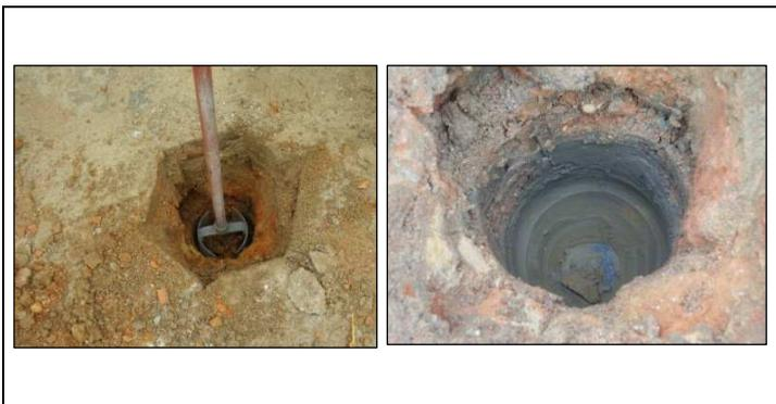
Figura 25 (A, B) - Fotografia da amostra b, utilizando trado para a coleta da argila e profundidade de coleta
