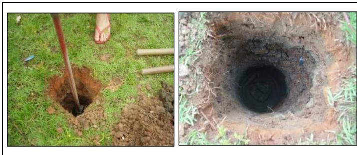
Figura 26 (A, B) - Fotografia da coleta da amostra c, utilizando trado para a coleta da argila e detalhe da profundidade de coleta
