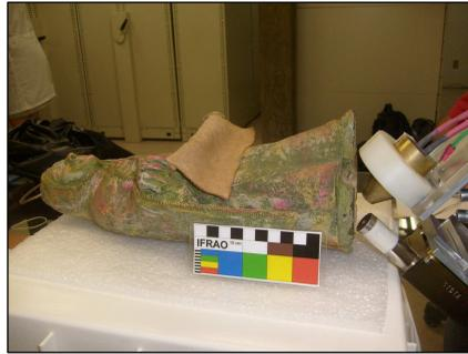
Figura 8 e 9 - Obra “Verônica” (09.29), com pontos a e b identificados para análise de fluorescência e na posição para análise
