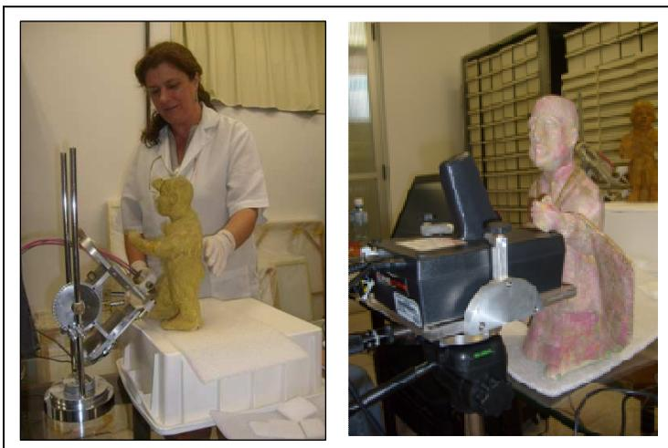
Figura 22 (A, B) - Fotografias de exames por meio de sistema portátil de EDXRF composto por detector de raios X, minitubo de raios X e eletrônica padrão para espectroscopia de raios X e espectroscopia de Raman realizados nas esculturas em argila policromada de Franklin Joaquim Cascaes, no Museu Universitário Professor Oswaldo Rodrigues Cabral da UFSC em 11 e 12 de abril de 2011
