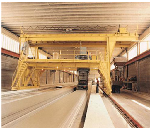
Figura 2-2 – Produção de lajes alveolares em pistas
