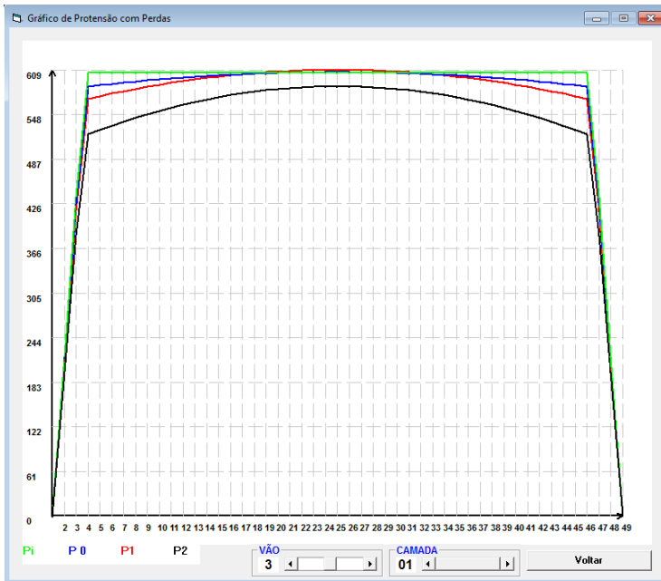
Figura 7-11 – Formulário com o gráfico das forças de protensão ao longo da peça
