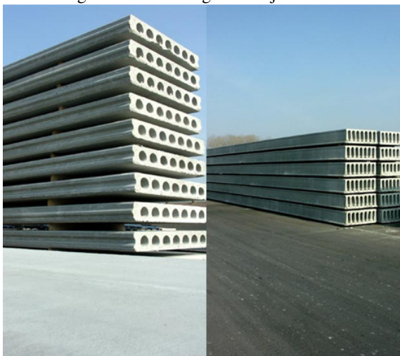
Figura 2-4 – Armazenamento dos painéis alveolares
