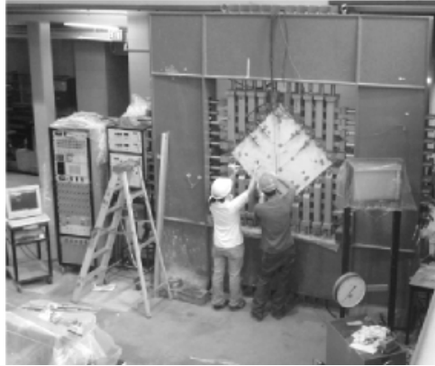
Figura 6-13 – Ensaio de painéis de concreto (Collins et. al, 2008)
