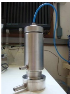
Figura 16: (a) aparelho de microfiltração e (b) tela metálica inferior.
