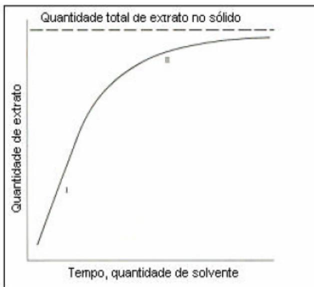
Figura 7-: Curva típica de extração Fonte: Brunner, 1994
