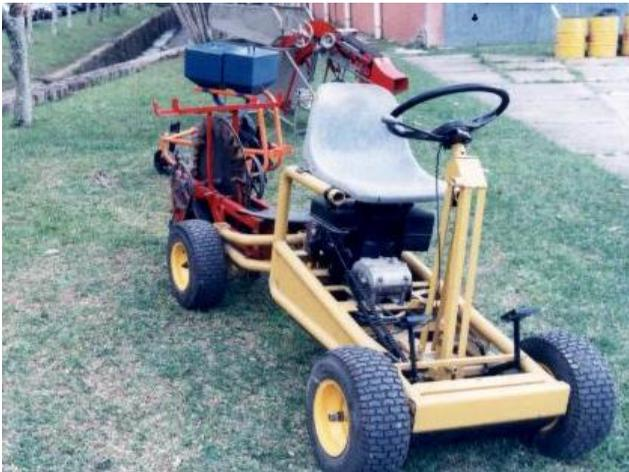
Figura 2.2: Protótipo de micro trator articulado e implemento de plantio e adubação por covas, acoplado (Fonte: RESENDE, 1995)
