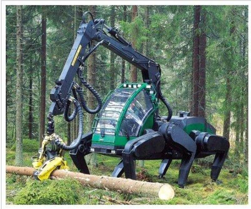
Figura 5.20 – Trator da Plustech (FONTE: <http://www.plustech.fi>, acessado em 04/03/09)
