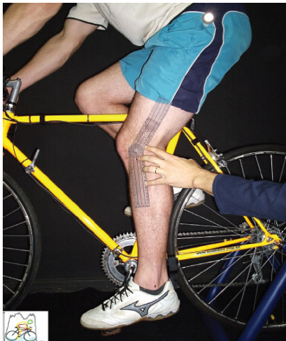
Figura 1 - Avaliação do ângulo do joelho, informação que serviu de base para ajustes no selim. Imagem ilustrativa. Adaptado de Martins et al. (2007).
