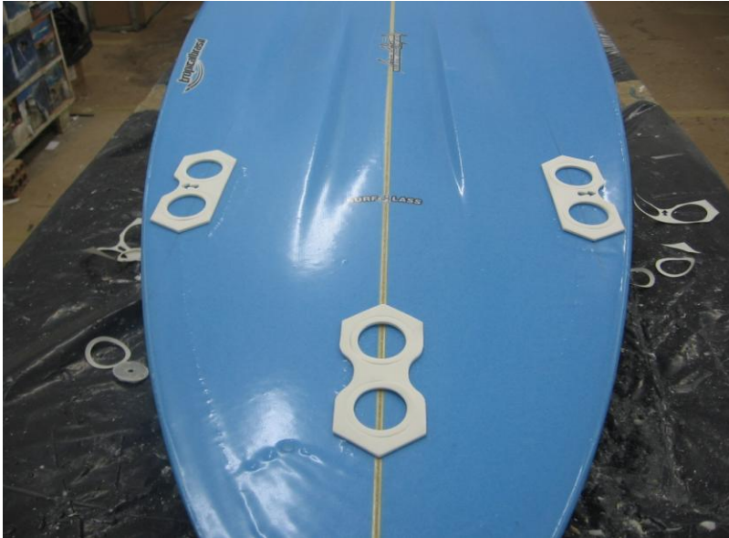
FIGURA 16– Colocação das quilhas
