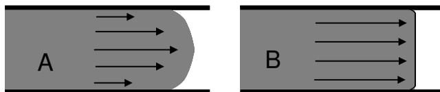
**Figura 1.3.** Perfil de fluxo gerado por pressão (A) e o fluxo eletrosmótico (B).
