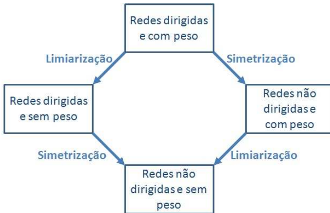
Figura 2.4 – Representação esquemática das relações entre os tipos de redes. (Adaptada de COSTA et al., 2007)
