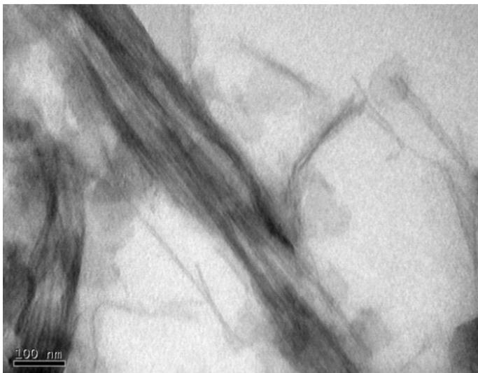
Figura 64: Micrografia MET de partículas do 2,1 C-S-H
