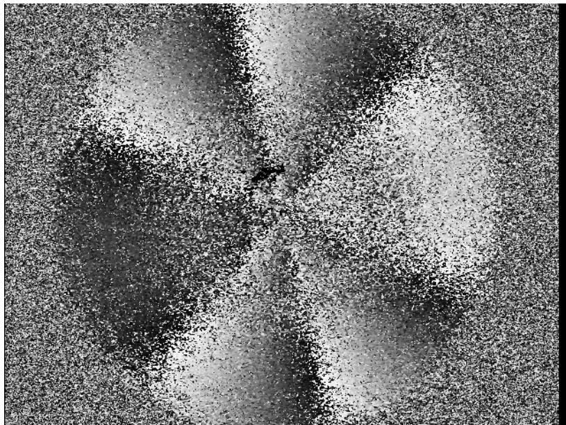
a) Imagem de diferença de fase do RIPI com espelho cônico
