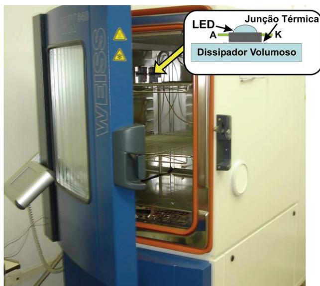
Fig. 2.61 – Dissipador com o LED inserido na câmara climática.
