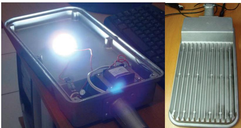
*Fig. 2.56 – Luminária para iluminação pública com um LED de alta potência (40 W).*
