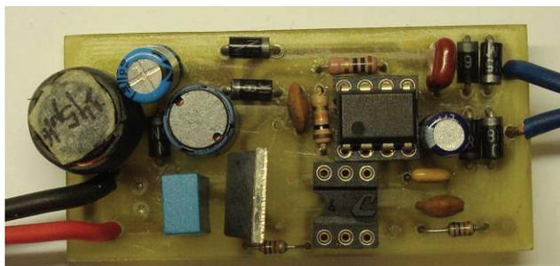
Fig. 3.36 – Foto do conversor buck quadrático implementado.
