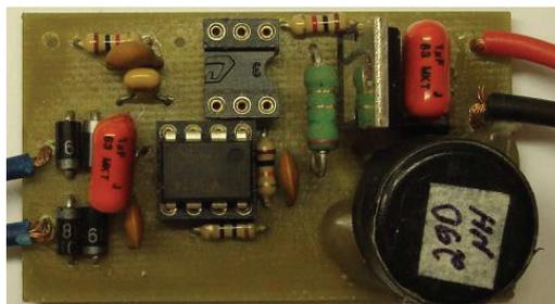
Fig. 3.30 – Foto do conversor buck implementado.
