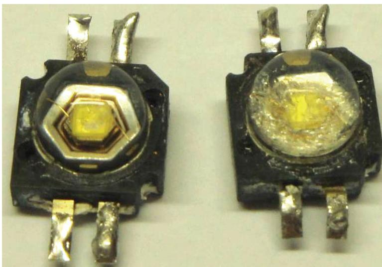
Fig. 2.46 – LEDs Luxeon K2 TFFC danificados por superaquecimento.
