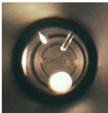
Figura 8: Detalhe da célula (janela de safira), com posicionamento do termopar e barra magnética.
