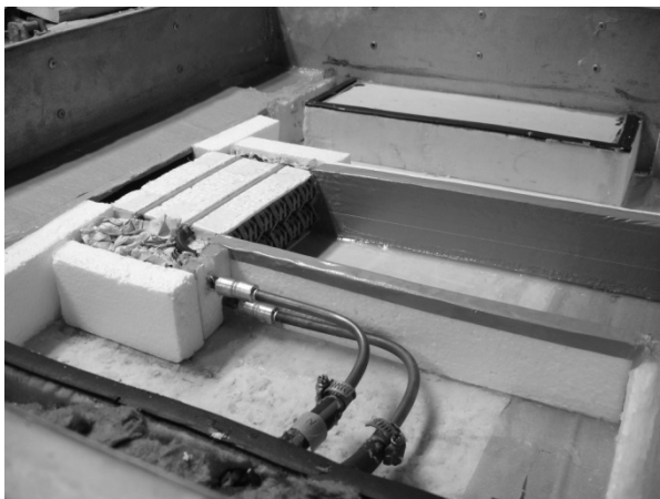
Figura 3.6 – Evaporador montado na seção de testes.
