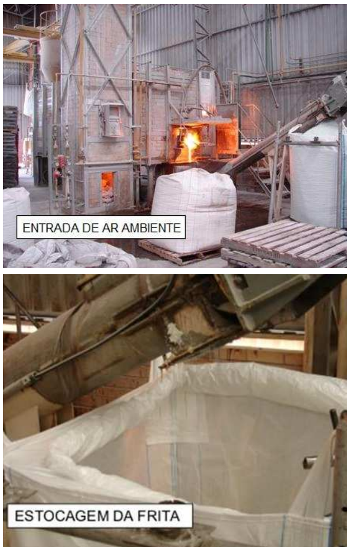
Figura 3. 3 - Entradas de ar ambiente na chaminé (superior) e estocagem da frita processada (inferior).
