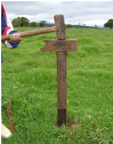
Figura 4: Cilindro utilizado para a coleta de raízes.
