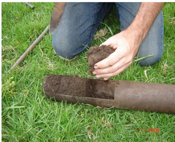
Figura 5: Amostras de solo prontas para serem retiradas do cilindro.
