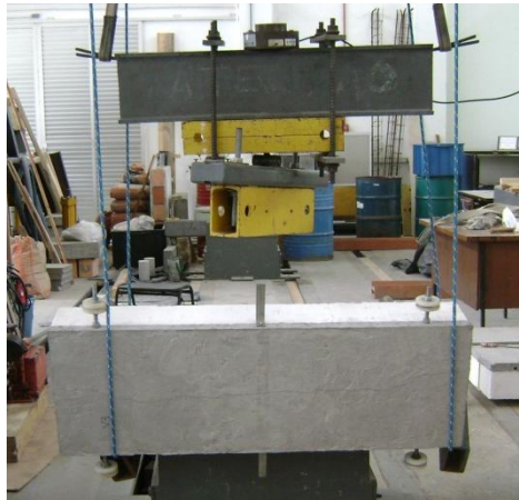
Figura 3.22 – Instabilidade global do V3
