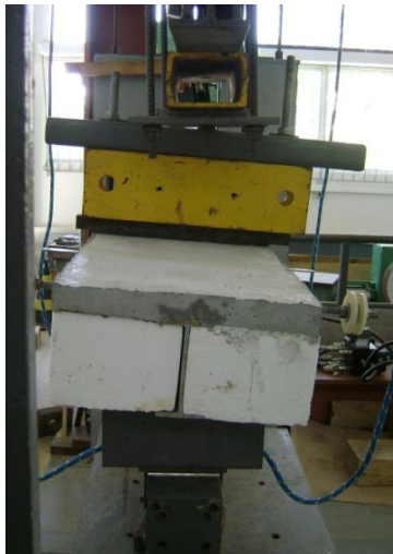
Figura 3.24 – Instabilidade do V4
