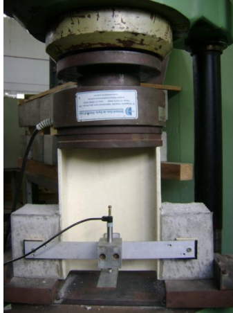
Figura 4.5 – Foto do ensaio de cisalhamento duplo
