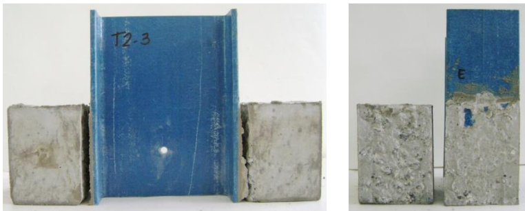
Figura 4.12 – Ruptura típica ( T_2 )
