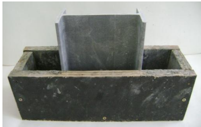
Figura 4.2 – Fôrma para os corpos-de-prova de aderência
