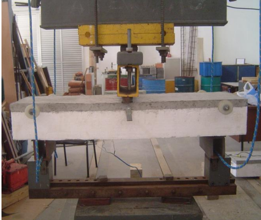
Figura 3.15 – Preparação do ensaio do vigote
