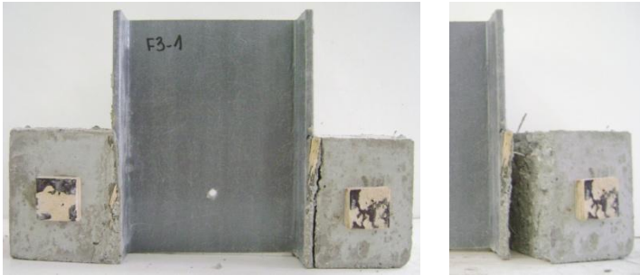
Figura 4.9 – Ruptura típica para fibra Durus 2%
