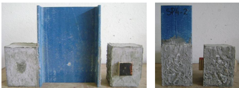
Figura 4.6 – Ruptura típica ( T_0 )
