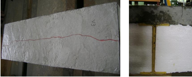
Figura 3.21 – Fissura no V3
