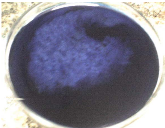
Fig. 4.3: Foto retirada de um eletrólito contendo 0,018 M \text{CoSO}_4 . Podemos notar o aparecimento de uma substância insolúvel.
