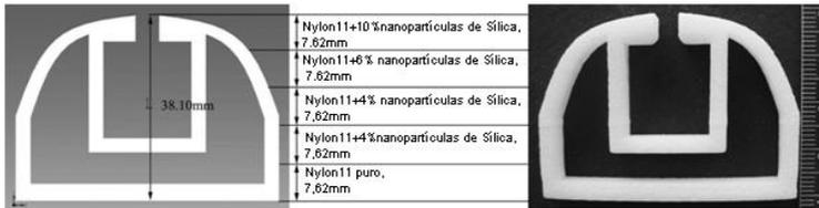
Figura 20- Descrição esquemática e a peça fabricada no formato de garra (Chung e Das , 2008).
