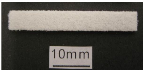
Figura 61 - Corpo de prova de PCL fabricado com 15% progesterona.
