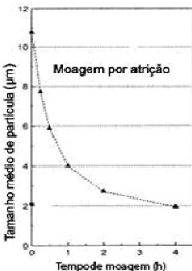
Figura 3.12: Influência no tempo de moagem no tamanho médio de partícula do TiB_2 . (SURYANARAYANA, 2001)
