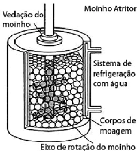
Figura 3.8: Esquema de funcionamento de um moinho por atrição (atritor). (SURYANARAYANA, 2001)
