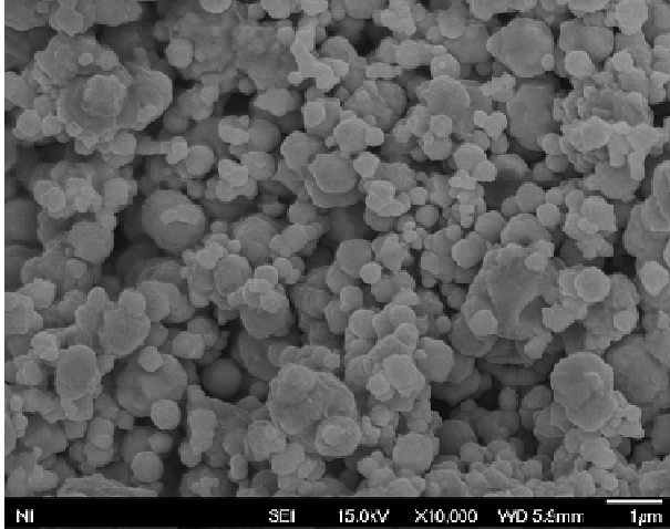
Figura 5.11: Micrografia FEG-MEV de amostra 100% Ni processado por colagem de barbotina.
