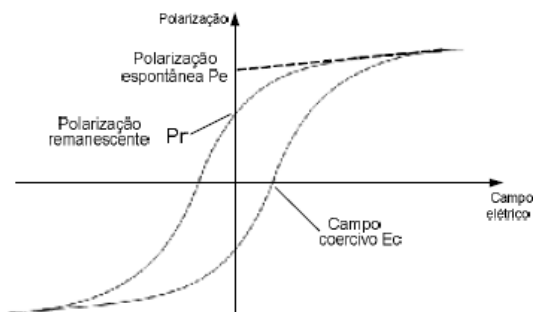
Fig.8. Curva de histerese típica para materiais ferroelétricos [24] .
