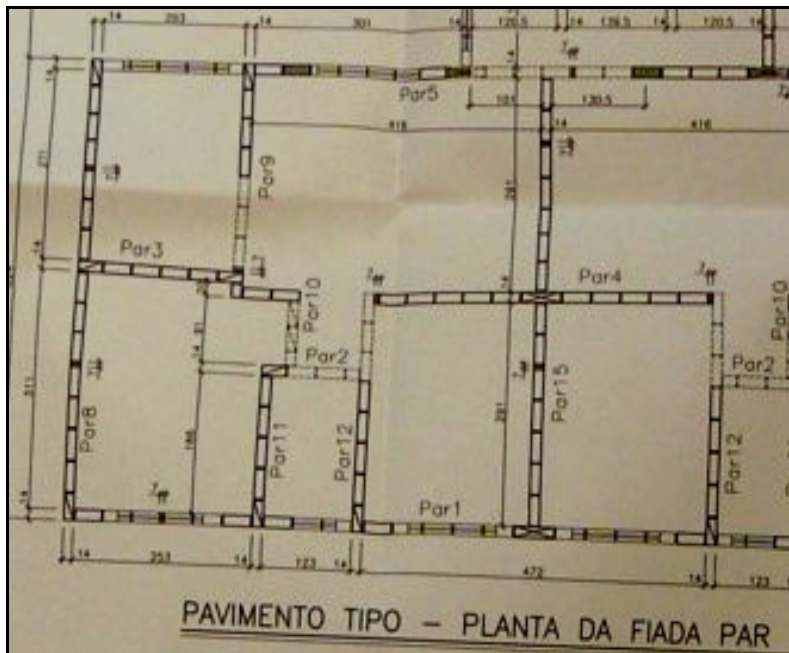
Figura 40 - Detalhe de fiada par. Fonte: Pesquisa de escritório, 2010.
