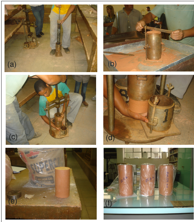
Figura 4.9 - Etapas da moldagem dos corpos de prova.
