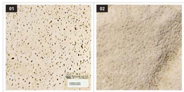
Figura 03 – Imagem comparativa entre um piso cimentício com características atérmicas (01) e um piso em pedra natural (02)
