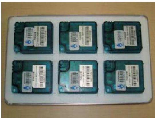
Figura 65: foto do equipamento utilizado para medições térmicas – pingüim.
