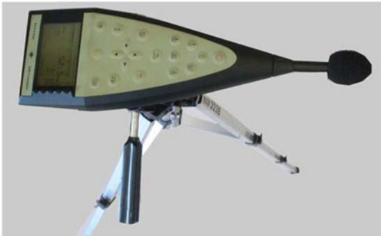
Figura 80: decibelímetro utilizado nas medições acústicas.
