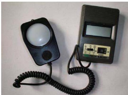
Figura 72: Luxímetro utilizado nas medições lumínicas.
