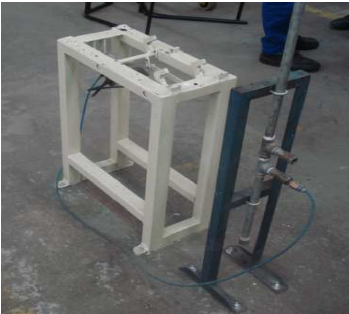
Figura 26 – Gabarito fixo - montagem do pega-mão
