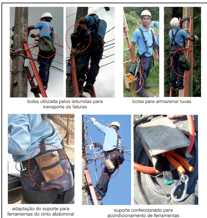
Figura 45: Suportes para ferramentas utilizados de forma improvisada pelos eletricitistas
