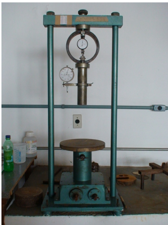
Figura 19 - Prensa utilizada no ensaio do ISC
