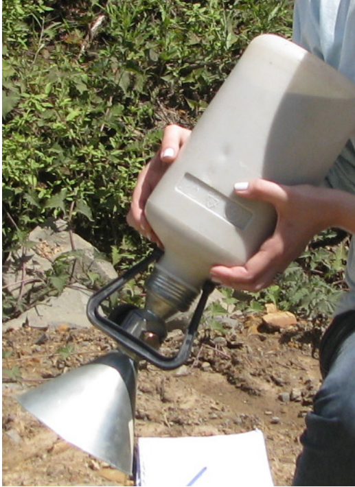
Figura 33 – Conjunto frasco e funil utilizado no Ensaio Frasco de Areia
