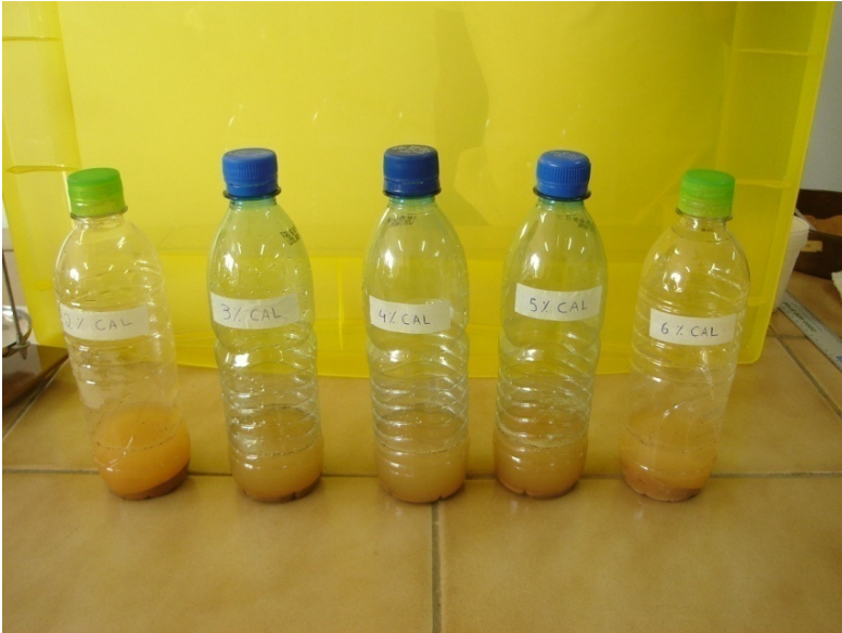
Figura 21 – Exemplos de Misturas Solo-Cal
