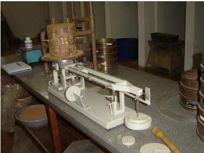
Figura 18 - Pesagem do cilindro durante o ensaio de compactação
