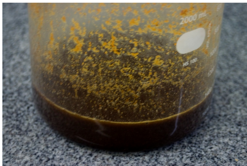
Figura 8. Oxidação das Cascas de Arroz.
