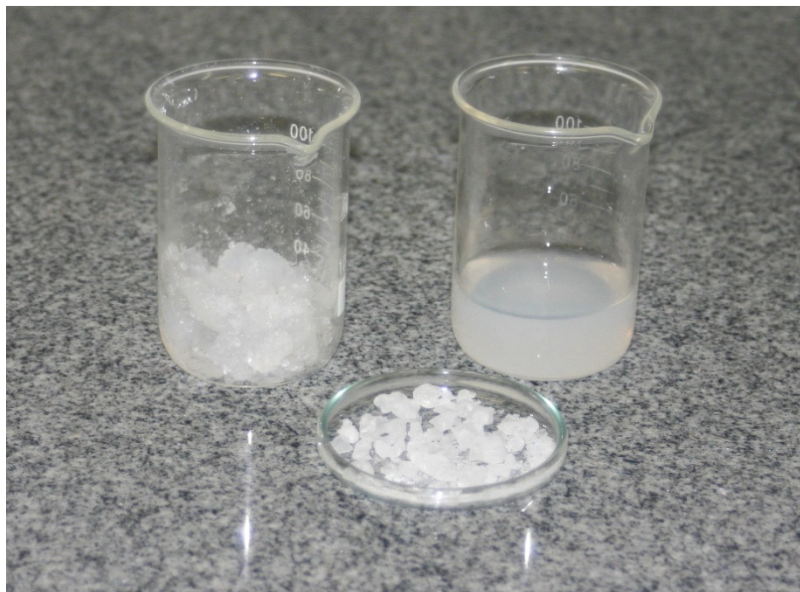
Figura 23. Aspecto visual das etapas de preparo do xerogel de sílica.
