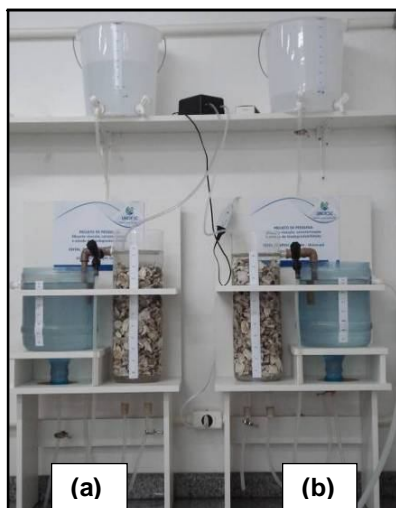
Figura 11: Esquema de alimentação durante os testes hidráulicos e para o período de fluxo descontínuo. (a) BAS 2 – Entressafra, (b) BAS 1 – Safra.
