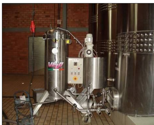
Figura 15: Filtro de placas verticais preenchido com terra diatomácea utilizado na vinícola.
