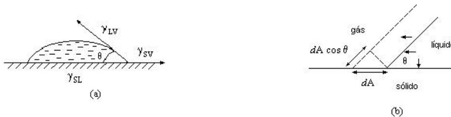
Figura 1: a) Ângulo de contato formado entre uma gota e a superfície de um sólido; b) Ângulo de contato na interface sólido-líquido-gás.
