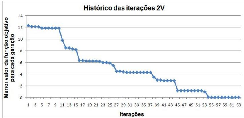
Figura 5.14: Iterações para o *muffler* de 2V utilizando-se os valores dos parâmetros modificados do GA.
