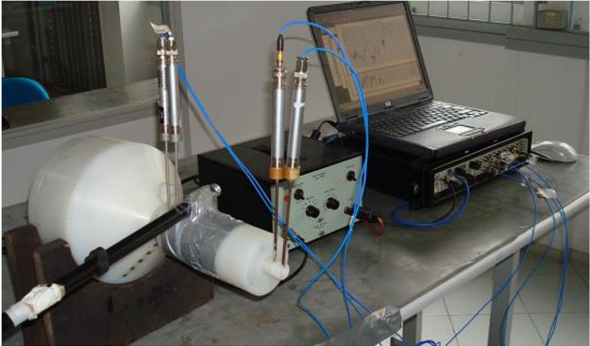
Figura 4.1: Bancada experimental para determinação dos parâmetros acústicos dos *mufflers* de 1V e 2V
