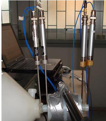
Figura 4.4: Pontos de medição da pressão sonora nos tubos de entrada e saída do *muffler* de 1V.
