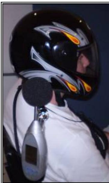
Figura 4.8: Posição 2 → posicionamento do microfone na parte látero-posterior do capacete.
