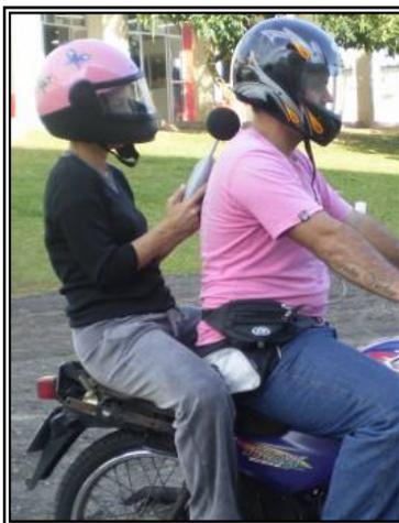
Figura 4.10: Posição 4 → posicionamento do microfone na parte posterior do capacete.
