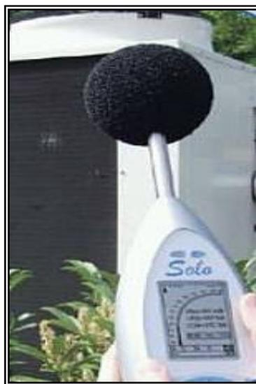
Figura 6.1: Medidor de NPS Solo 01 dB
