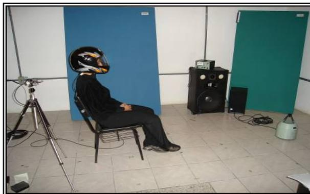
Figura 5.13: Posicionamento do usuário no centro da Câmara reverberante com o capacete ocluído, a fonte geradora de ruído e o microfone externo.
