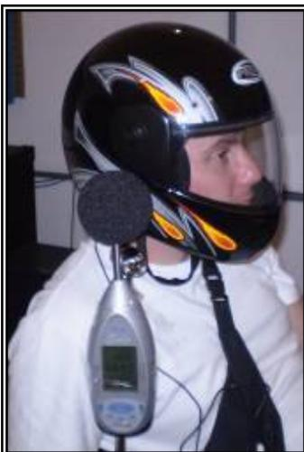
Figura 4.9: Posição 3 → posicionamento do microfone na parte lateral do capacete.
