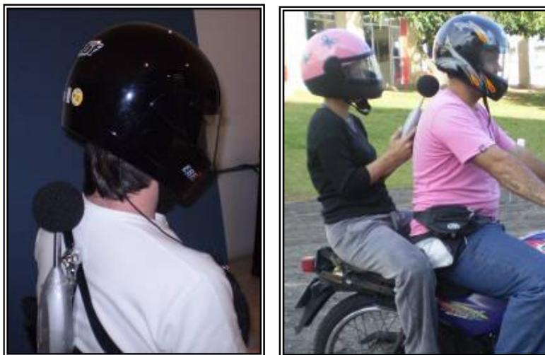
Figura 6.11: Posicionamento do microfone, com o protetor de vento, durante a corrida.
