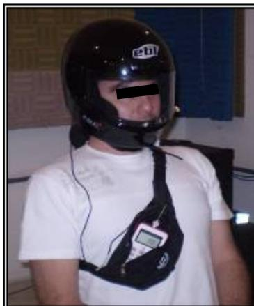
Figura 6.10: Posicionamento do dosímetro no moto-táxista durante a corrida de motocicleta
