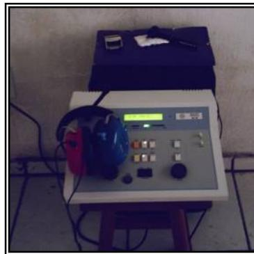
Figura 6.7: Audiômetro AD28 usado para avaliação auditiva
