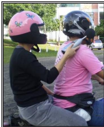
Figura 4.12. Posição 6: posicionamento do microfone na parte lateral do capacete.
