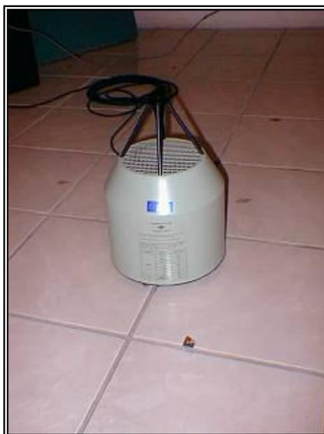
Figura 4.3; gerador de sinais ruído branco utilizado durante a comparação entre os equipamentos
