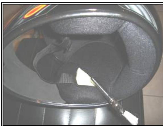
Figura 5.14: Capacete com o espaço destinado para a orelha ocluído por espuma e microfone posicionado para a medição
