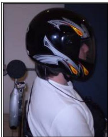
Figura 4.7: Posição 1 → posicionamento do microfone na parte posterior do capacete.
