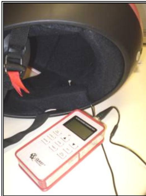
Figura 4.6: posicionamento do microfone internamente ao capacete
