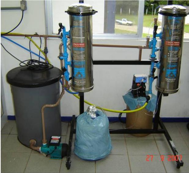
Figura 3: Sistema utilizado para testes da aplicação de CP e ZF em leito fixo.
