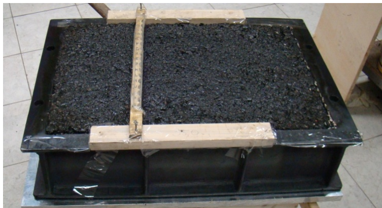
Figura 48 – Expansão volumétrica da massa após compactação, primeira placa.
