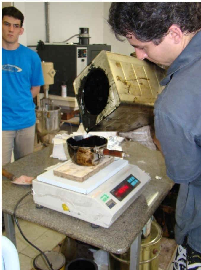
Figura 42 – Ligante betuminoso em estufa na temperatura de mistura.
