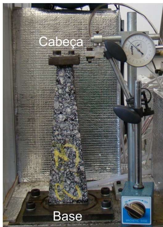
Figura B.2 – Fixação do Corpo de Prova
