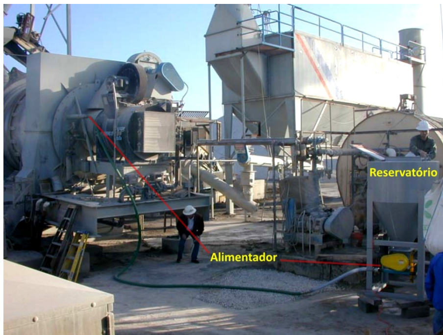
Figura 4 – Alimentador e reservatório para zeólita Aspha-min.
