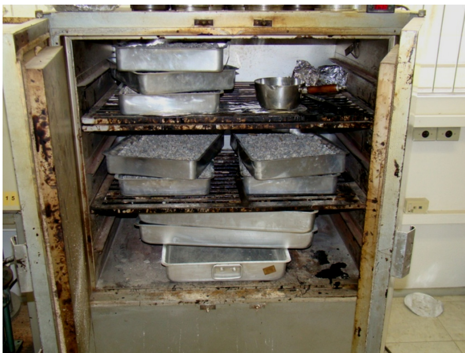
Figura 41 – Materiais granulares para uma placa, separados em bandejas.
