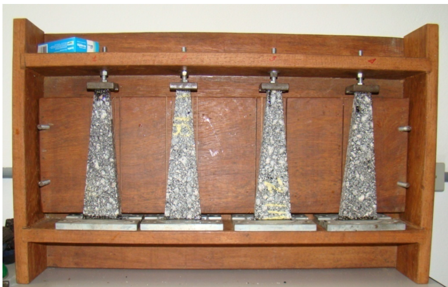
Figura 56 – Colagem dos corpos de prova sobre os suportes metálicos.
