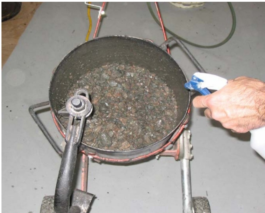
Figura 5 – Introdução de umidade no agregado para o ensaio TSR.
