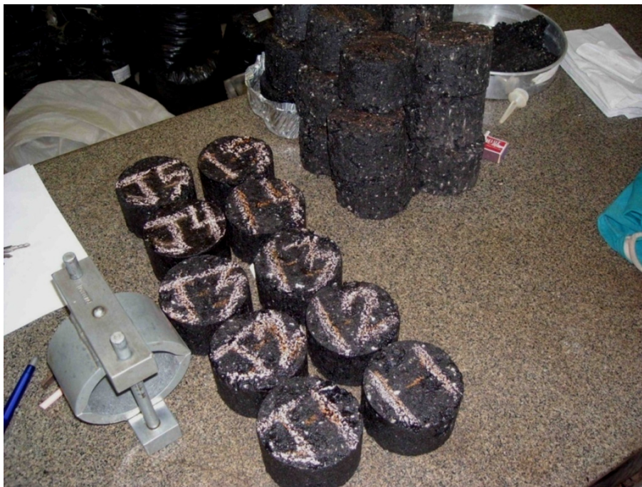
Figura 36 – Corpos de Prova Marshall ensaiados.
