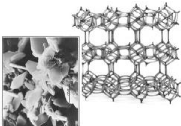
Figura 34 – Imagem por microscopia eletrônica e estrutura representativa da clinoptilolita.
