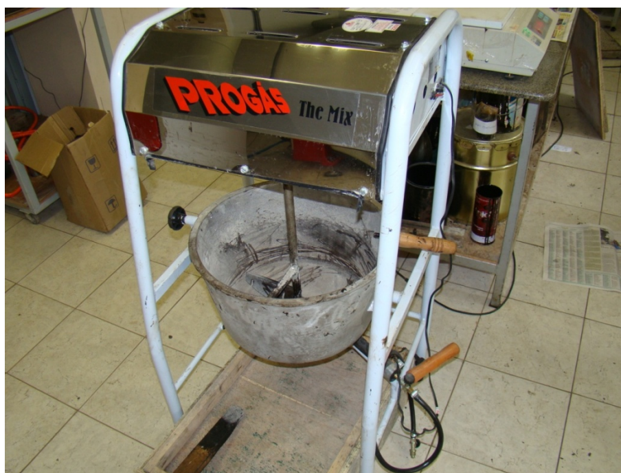
Figura 44 – Misturador modificado para mistura da massa asfáltica.
