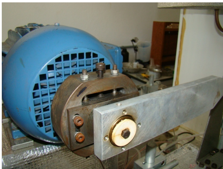
Figura B.5 – Excêntrico de flexão alternada.
