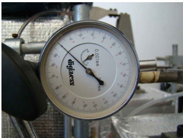
Figura B.4 – Micrometro “relógio”.
