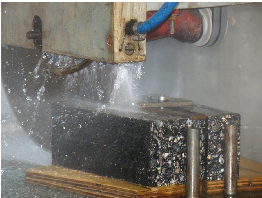
Figura 53 – Corte das plaquetas dos corpos de prova.
