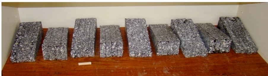
Figura 54 – Trapézios finais cortados prontos para triagem.
