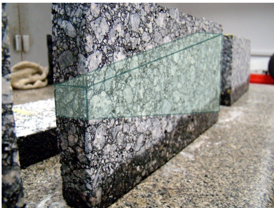
Figura 52 – Plaqueta dos corpos de prova (quatro por vez).
