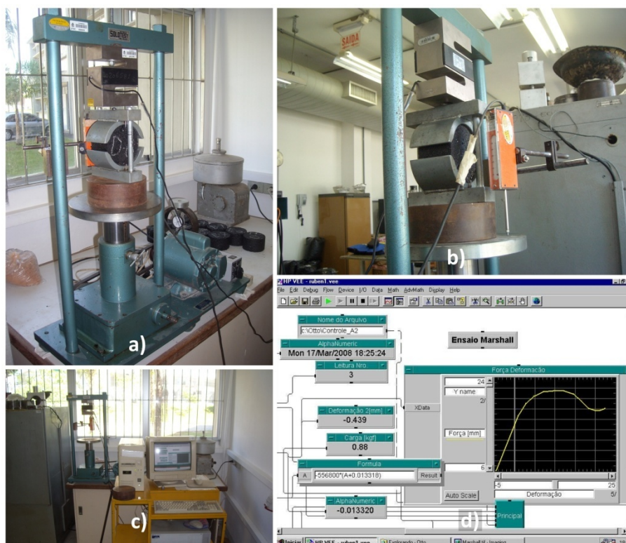
Figura 37 – Prensa Marshall, determinação da estabilidade e fluência.
