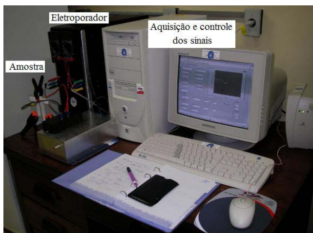
Figura A2.1 – Eletroporador desenvolvido para estudo da eletroporação. Possibilita a aplicação de formas de onda (pulso, rampa e senóide). O programa gráfico foi desenvolvido em Labview.
