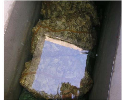
**Figura 11.** Biofiltro do sistema de recirculação
