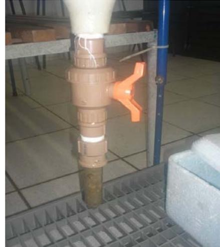
**Figura 4.** Detalhe do tubo de coleta de fezes
