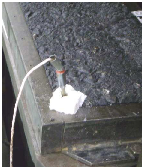
Figura 8.13 - Sonda térmica para monitoramento da temperatura da placa durante o ensaio.
