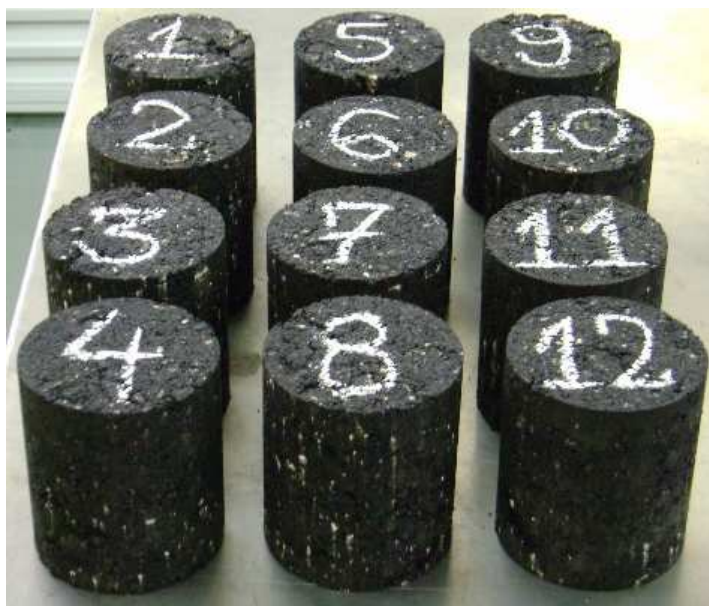
Figura 8.7 - Corpos de prova após desmoldagem durante o período de cura.
