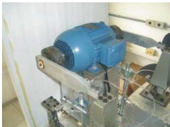
Figura 8.17 - Eixos excêntricos interligados ao rotor do motor da máquina.
