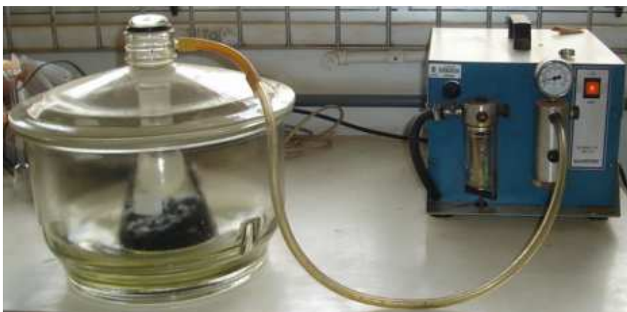
Figura 8.1 - Procedimento para determinação da massa específica volumétrica real dos granulares e das misturas asfálticas sob pressão a vácuo.
