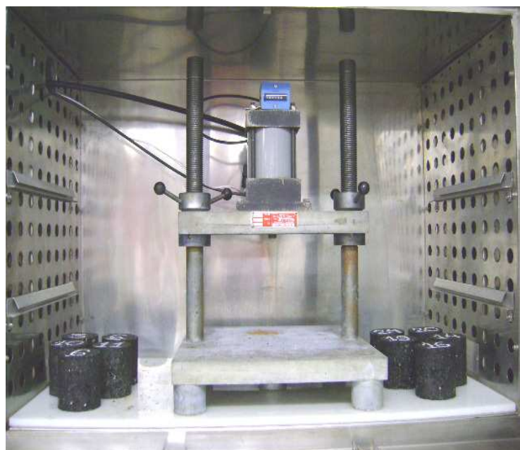
Figura 8.8 - Corpos de prova condicionados em câmara térmica (18°C e umidade relativa do ar a 50% ± 10%).
