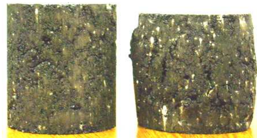
Figura 9.7 - Corpos de prova (a) antes e (b) após a ruptura.
