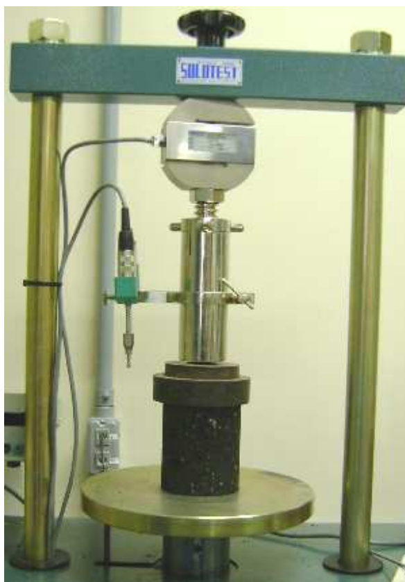
Figura 8.10 - Corpo de prova durante o processo de ruptura à compressão simples.
