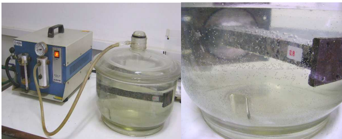
Figura 9.16 - Procedimento de saturação dos corpos de prova sob pressão de vácuo.
