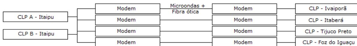
Figura 4.3 – Arquitetura do ECE do tronco de 765 kV
