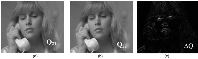
Figura 4 - Sequência de vídeo Suzie . (a) Componente de luminância do quadro #21. (b) Componente de luminância do quadro #22. (c) Diferença temporal entre os componentes de luminância dos quadros #21 e #22.
