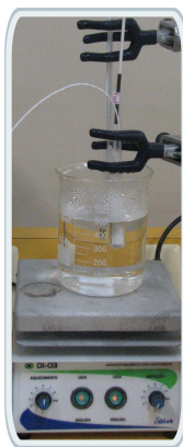
Figura 4.42: Verificação dos sensores Pt100 e termopar do tipo K a 100 °C
