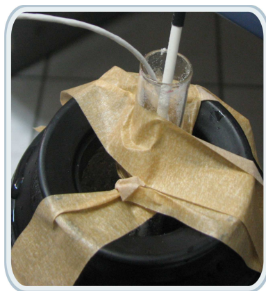
Figura 4.41: Verificação dos sensores Pt100 e termopar do tipo K a 0 °C
