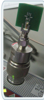
Figura 4.3: Resistor SMD de 47 \Omega utilizado para levantamento dos componentes da interface
