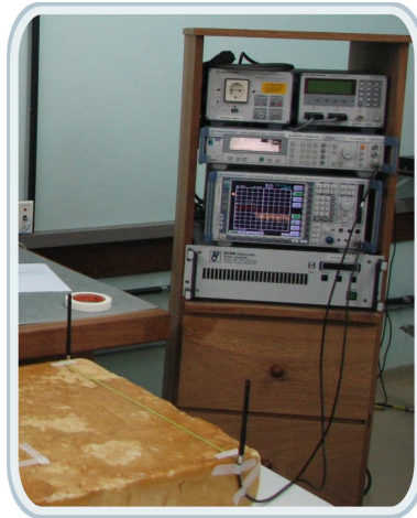
Figura 4.11: Teste das antenas comerciais
