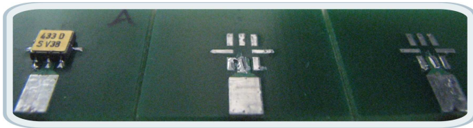
Figura 4.32: Placas de circuito impresso nas configurações aberto, curto e DUT
