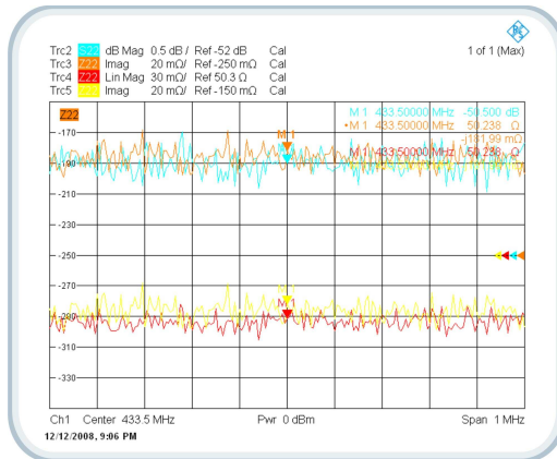
Figura 4.14: Resposta constante da base ao longo da faixa de medição
