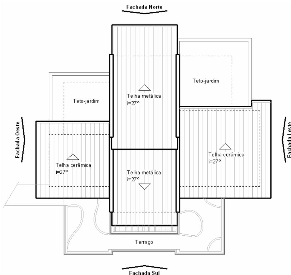
Figura 29. Planta de cobertura da Casa Eficiente.
