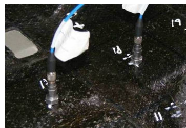
Figura 4.18: Posicionamento dos Acelerômetros sobre a camada de Manta Asfáltica
