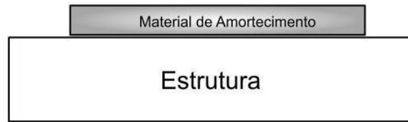
Figura 2.12: Esquema de material viscoelástico de camada livre.
