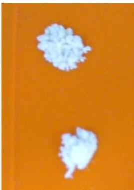
**Figura 2.1:** Imagem dos vidros após tratamento térmico a  $400^{\circ}\text{C}$ , onde **a:** vidro com prata; **b:** vidro sem prata.
