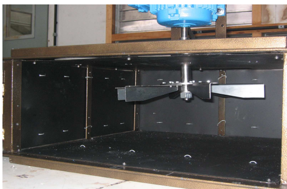
Figura 3.4 – Vista do ventilador acoplado ao forno.
