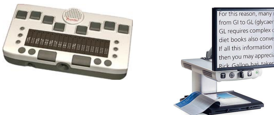
Figura 6 – Computador braile e amplificador de tela. Fonte: Tecnologia Assistiva (2009)
