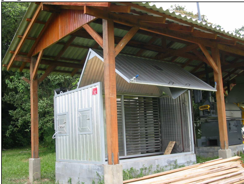
FIGURA 4.3: Unidade piloto de secagem de madeira serrada.
