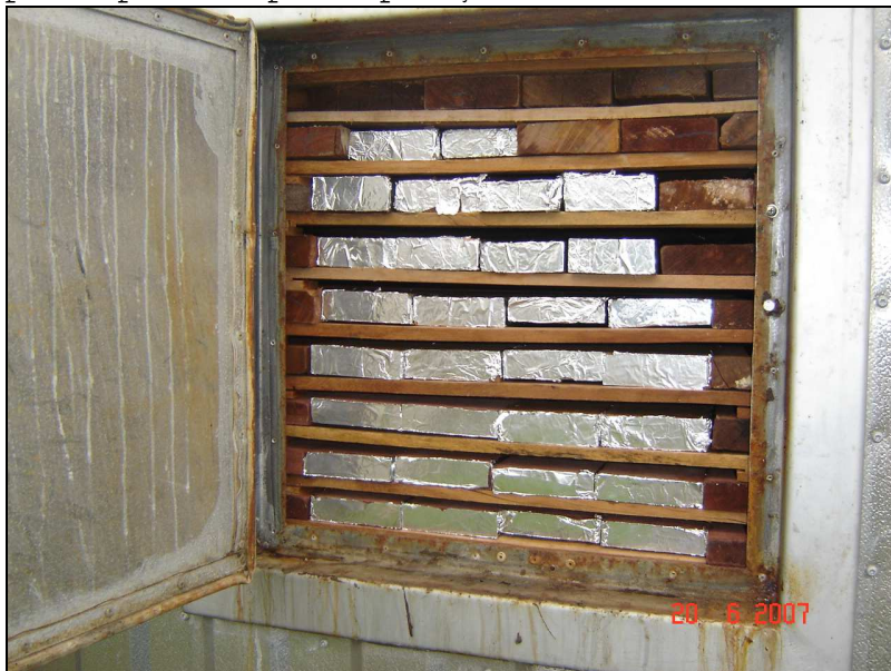
FIGURA 4.2: Visão através da janela de inspeção, das amostras submetidas à secagem.
