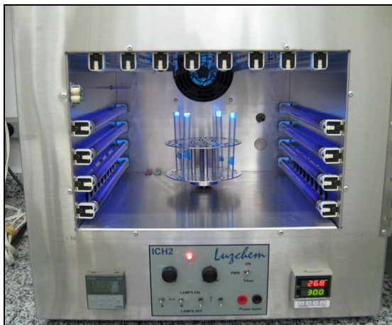
Figura 15: Câmara UV com lâmpadas de comprimento de onda de 366 nm.
