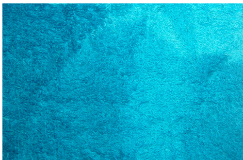
Figura 63: Amostra 5 – tecido recoberto com PVP, reticulado, lavado e tingido com azul turquesa.
