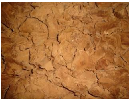
Figura 26 – Lama vermelha em torrões após secagem em estufa
