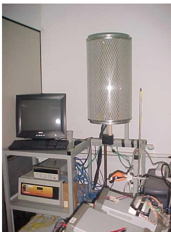
Figura 28 – Equipamento de análise térmica diferencial
