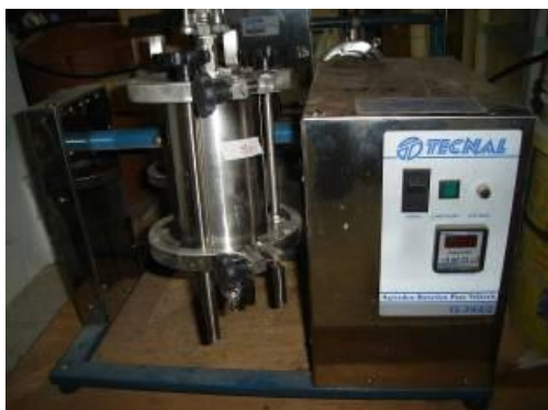
Figura 33 – Agitador utilizado no ensaio de lixiviação
