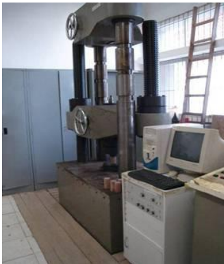
Figura 42 – Prensa utilizada para o ensaio de resistência à compressão
