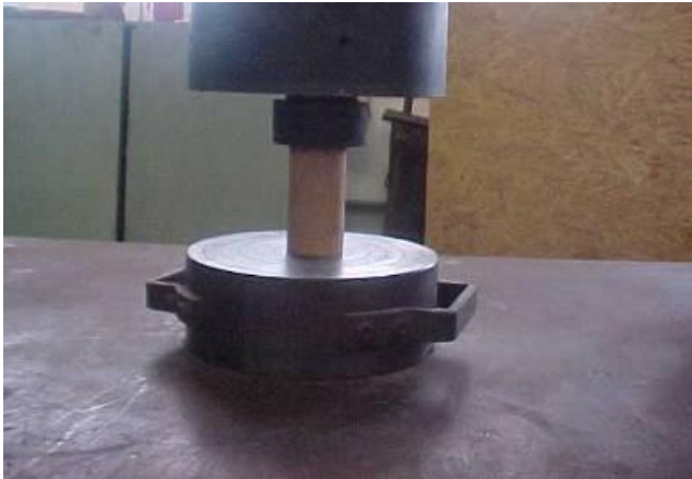
Figura 36 – Ensaio de resistência à compressão nas argamassas
