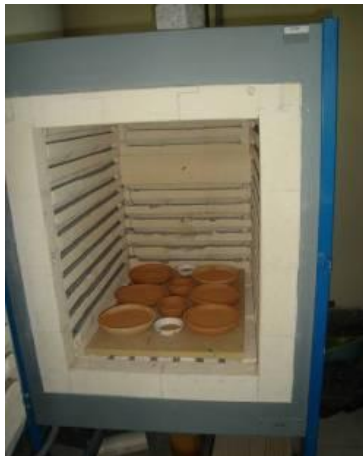
Figura 29- Amostras de lama vermelha na mufla utilizada para calcinação
